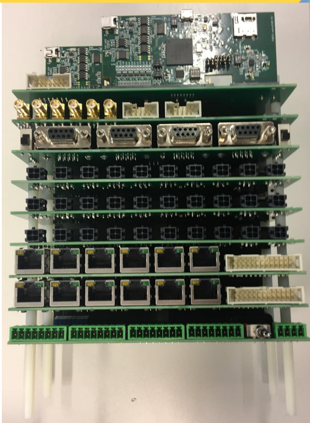
Rys. 3. Platforma sterująca modułowego przekształtnika wielopoziomowego.
